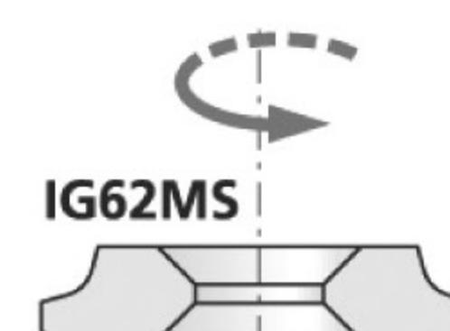
Fréza je osazená 4 hlavními a 4 předřezovými HM noži. Hlavní nože jsou uloženy šikmo v těle nástroje. Nástroj má připravena lůžka pro nože typu IG. Osazení v systému výmenných HM nožů. Tělo frézy je vyrobeno ze slitiny lehkých kovů. Cena nástroje zahrnuje základní osazení noži - ne nože IG.
